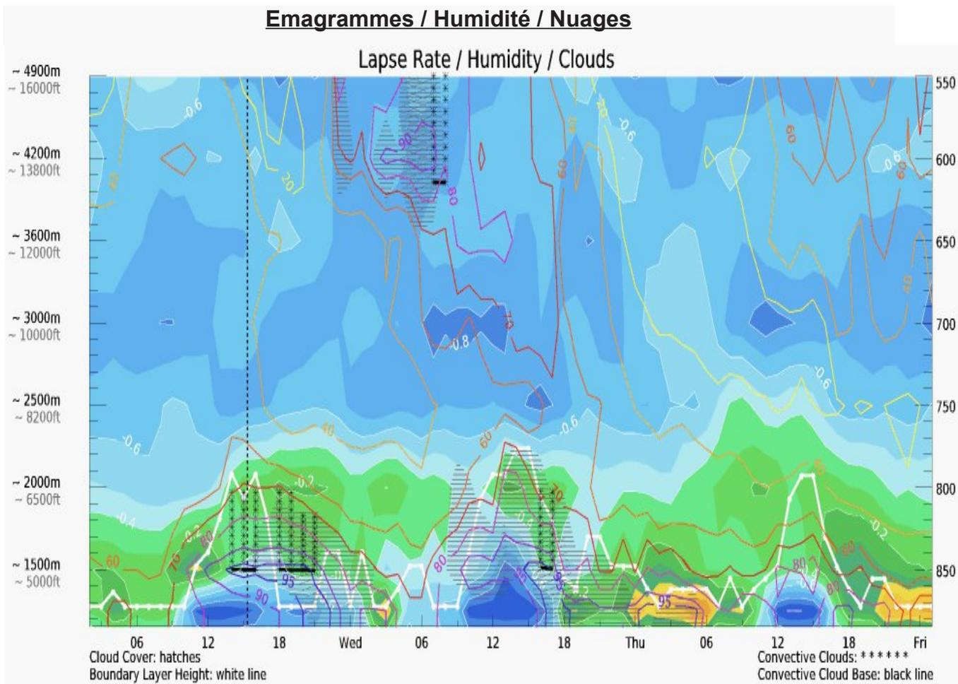
Ce diagramme montre en fausses couleurs l'évolution prévue de l'émagramme, de l'humidité et des nuages sur 3 jours. **C'est le diagramme le plus important pour estimer la stabilité thermodynamique et les plafonds.** Le bas du diagramme correspond au niveau du sol. Toutes les échelles de couleurs sont fixes pour comparer les prévisions à différents endroits et moments.
