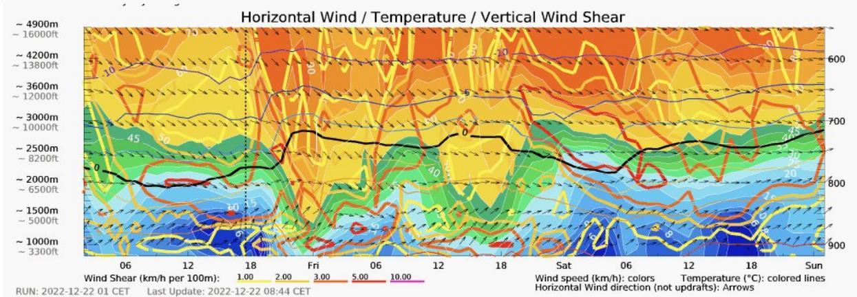
Ce diagramme montre en fausses couleurs les paramètres de vent, température et les surfaces de cisaillement de vent en fonction de l'altitude et du temps (3 jours)
